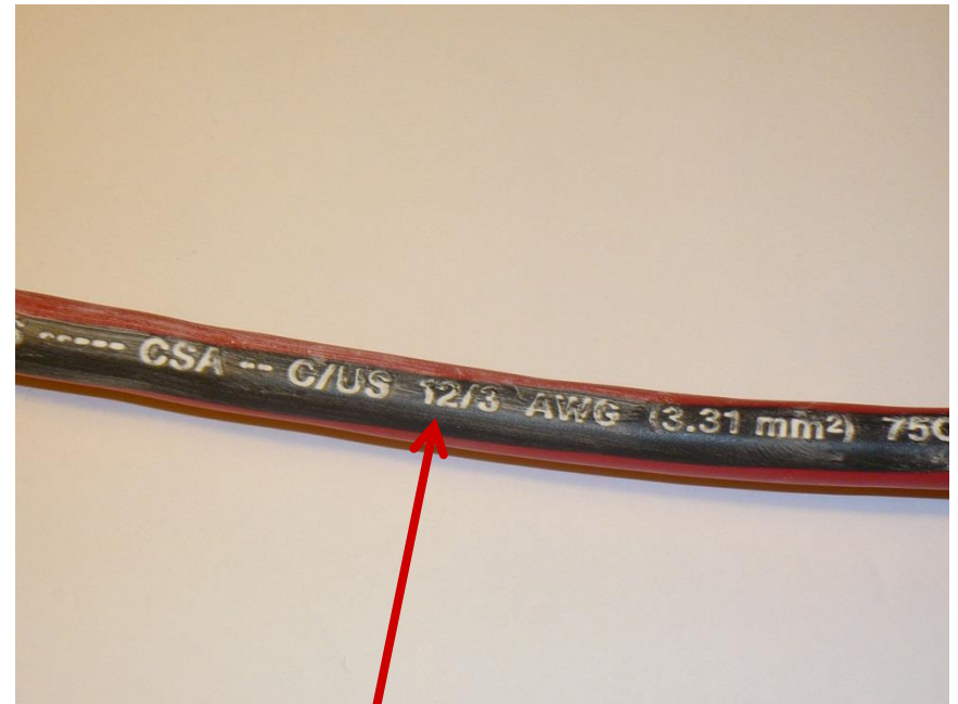
Cable rotulado que muestren el calibre de los alambres (3-12) (amperaje varía con la longitud del cable)
