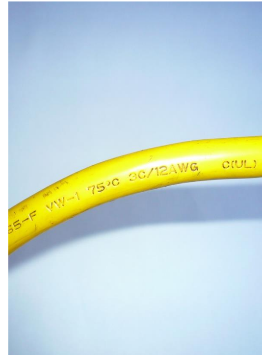
Cubierta del cable eléctrico que sirve como aislamiento
